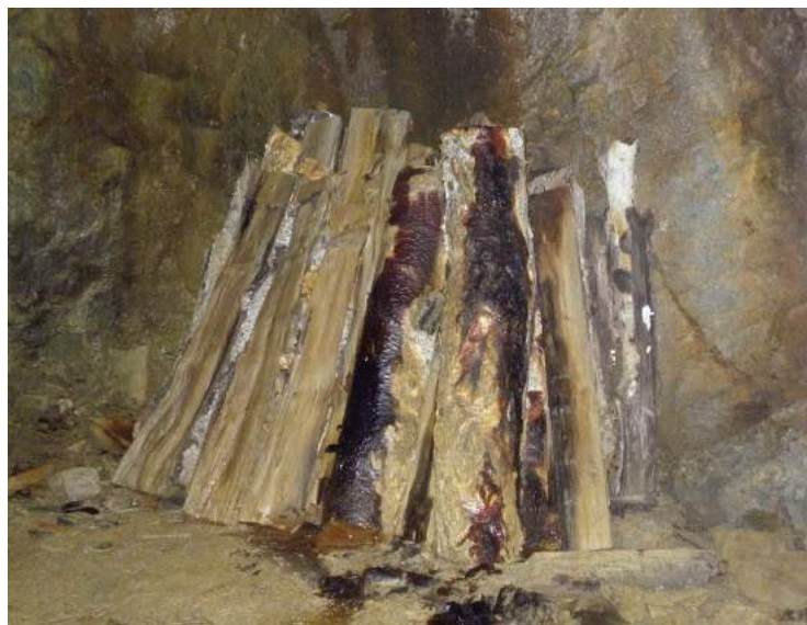
Feuersetzen im Silberbergwerk von Sala (Schweden)
